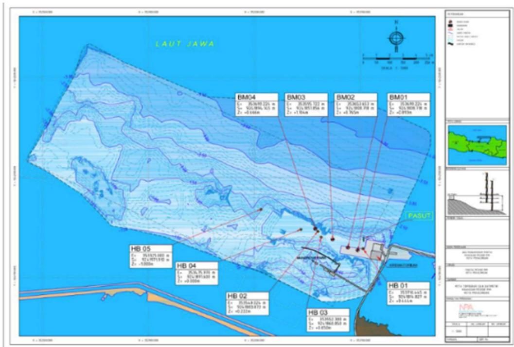
Gambar 5-20. Snapshot dari Hasil Pengukuran Gridding Situasi dan Batimetri (1)
